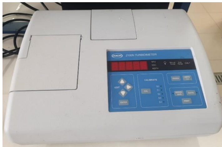
Figura 3.7 - Equipo de medición de turbidez (turbidímetro 2100N de Hach) disponible en el Laboratorio de Tratamientos Solares de Agua de la PSA.
